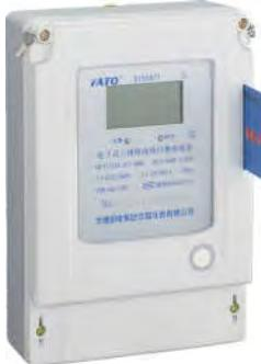
DT/SSY877型电子式三相预付费电能表是我公司开发研制的新一代预付费有功电能表。它采用最新的专用三相电能计量芯片进行电能计量：专用CPU进行数据处理、显示和控制继电器动作，采用独特的卡口安全及保护措施；动态、安全可靠的IC卡加密机制，先进的硬件及软件容错处理；可靠的电网监测及抗干扰电路设计，表内选用高精度电流互感器，采用专用的三相供电电源电路。具有运行可靠、精度高、过载能力大、自身功耗低、体积小、重量轻、寿命长、性价比高、便于安装等特点。能准确实现对频率为50Hz的三相交流有功电能的计量及实现预付费。该产品的全部性能和技术指标符合GB/T18460、GB/T17215(IEC61036)的相关指标。
