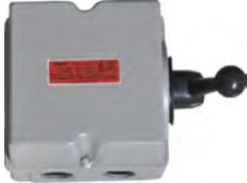
CFL1系列组合式万能转换开关，适用于交流频率为50Hz，交流额定工作电压至400V，交流额定工作电流至100A，作为电动机起动，变速，换向和主电路与备用电路的转换使用，本开关采用铸造铝外壳，银合金触点及高阻燃塑料主体结构，具有外观新颖，使用方便，高电气性能特点。
